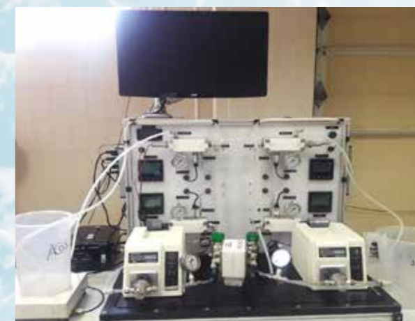
الوحدة المخبرية لتقنية التناضح المباشر المستخدمة في التجارب
