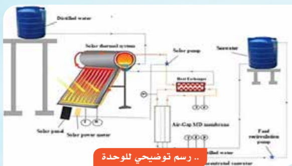
وحدة الاختبار التجريبية للتقطير الغشائي ذات الضجوة الهوائية
