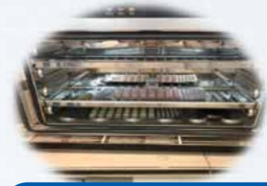
ادخال الـ Envelop Or Sheet Testing في الحاضنة في درجة الحرارة (35°C) لمدة 24 ساعة
